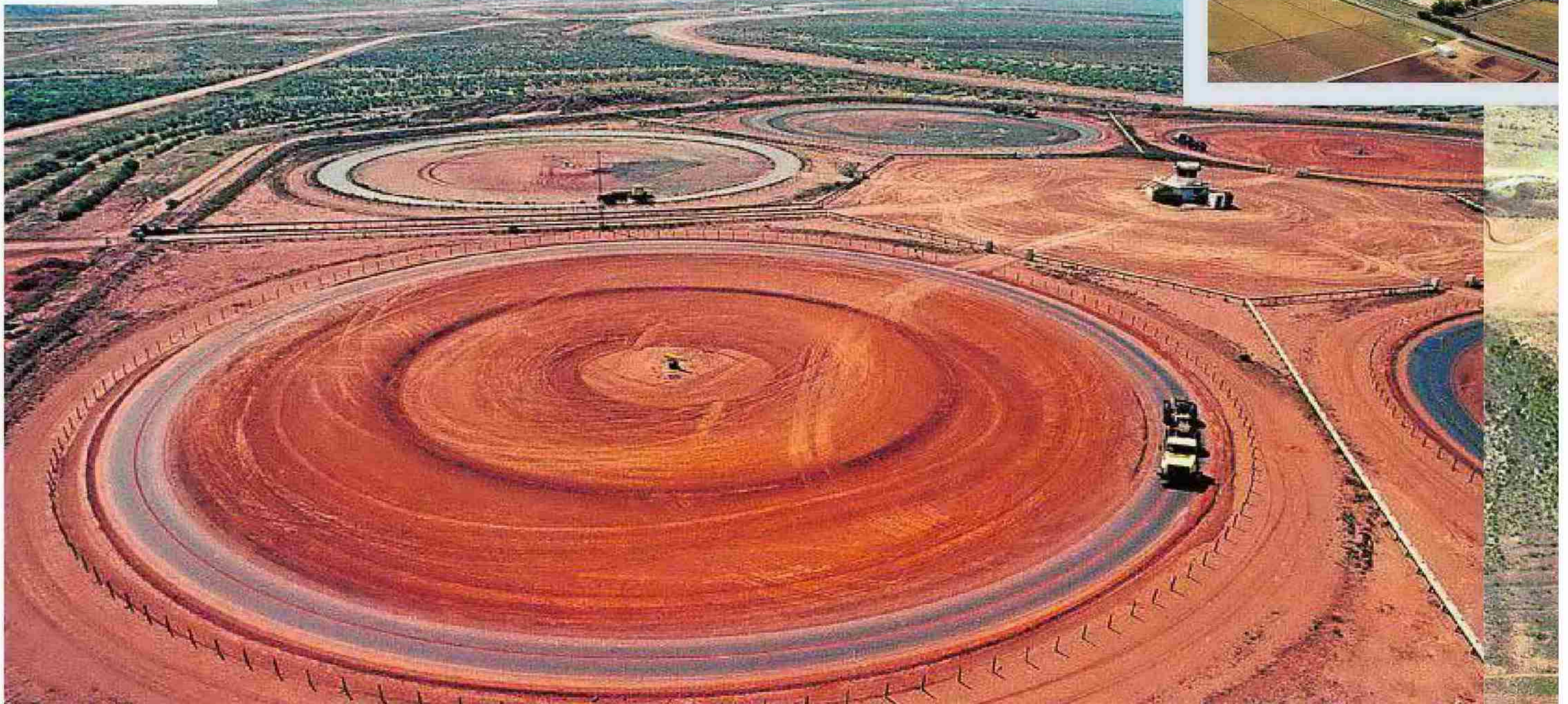
Pistas donde los camiones ruedan, sin conductor, durante las 24 horas del día probando la resistencia de los neumáticos.
